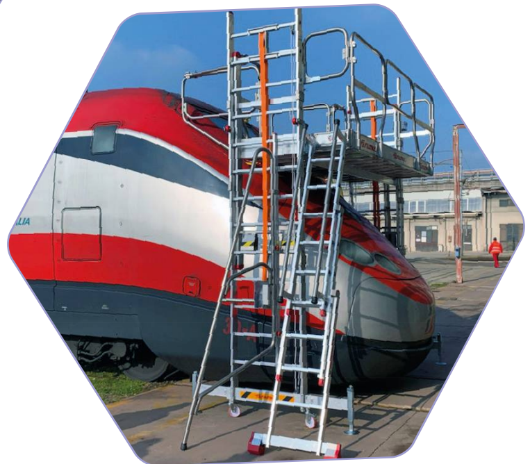
Scala a ponte; piano con sbalzo laterale dotato di cancello d'accesso e scala d'accesso regolabile in altezza.
